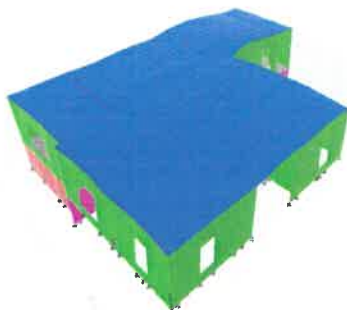
Modul 1 de vibratie (vedere 3D, vedere plan)
