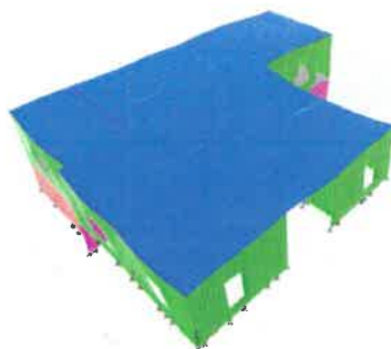
Modul 2 de vibratie (vedere 3D, vedere plan)
